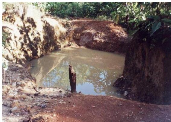
*Figura 23. Excavación (retroexcavadora) efectuada para extraer oro, Municipio de Puerto Guzmán.
