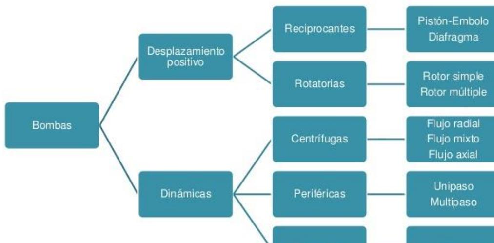
Figura 2. Clasificación de Bombas según el Instituto de Hidráulica de los E.E.U.U. (1984). Fuente Recuperado de <https://www.mecanicoautomotriz.org>.
