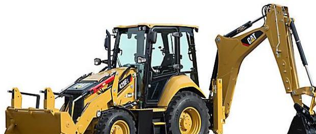
Figura 16. Retroexcavadora sobre ruedas. Fuente Richard M. Mamani Limachi, 2000
