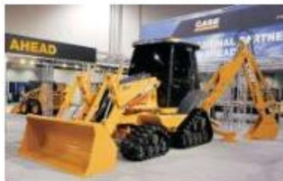
Figura 17. Retroexcavadora sobre oruga. Fuente JCB Service, 2000.
