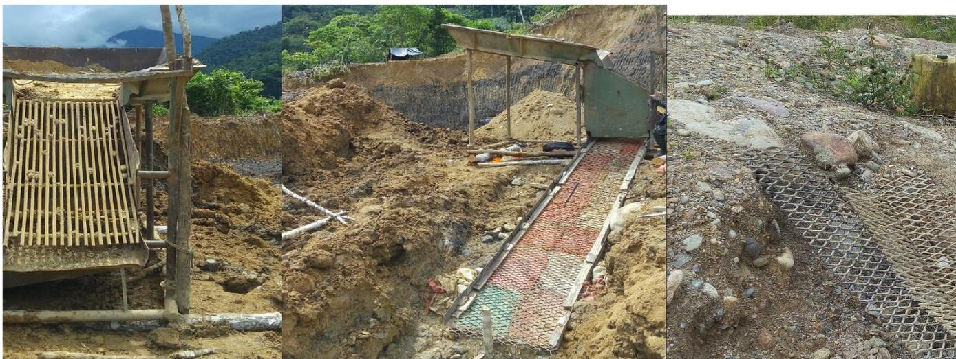
Figura 8. Malla metálica empleada en la minería ilegal de oro. Fuente CORPOAMAZONIA, 2017f.
