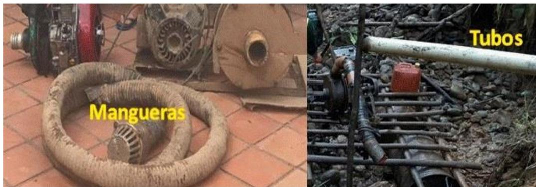
Figura 7. Manguera industrial y tubería PVC empleada en la minería ilegal de oro. Fuente CORPOAMAZONIA, 2017e.
