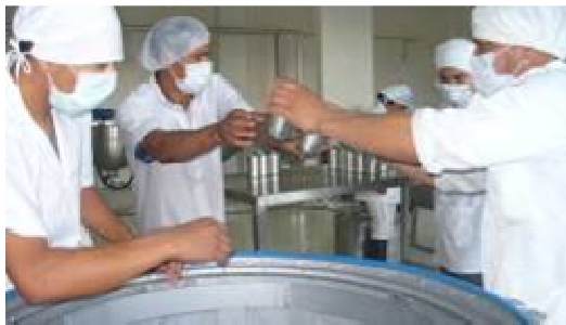
Operarios colocando las latas en la autoclave
