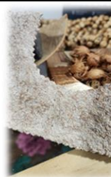
Fabricación del ladrillo ecológico a partir de residuos generados en la cadena de valor del asaí.” de la empresa Chatarrería El Pollo VS SAS ZOMAC BIC (Orito, Putumayo)
