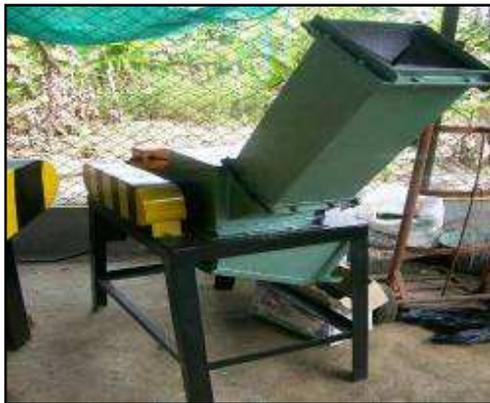
Foto 22. Mantenimiento y pintura molino de vidrio
