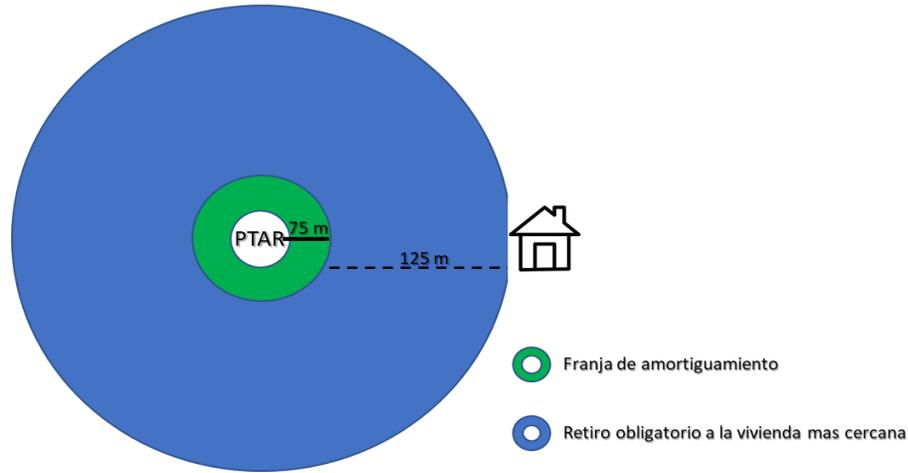
Para las nuevas PTAR, según el tipo de tratamiento del agua residual, se deben aplicar las distancias mínimas según el Art. 138 Resolución 330 de 2017.
