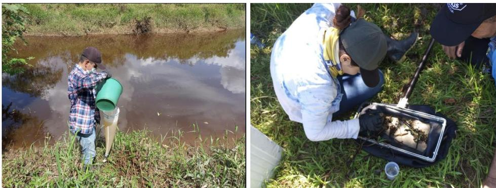
**Figura 48.** Toma de muestra de agua para el análisis físico químico e hidrobiológico del agua.
