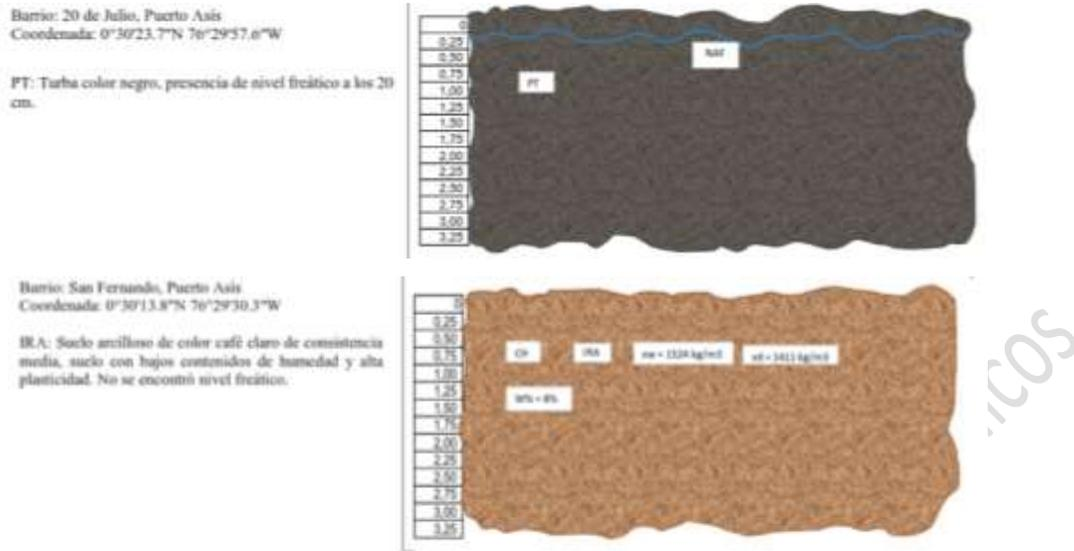
**Figura 38.** Ejemplo de Estratificación del subsuelo obtenida mediante sondeos directos para corroborar la litología del Grupo Orito y Depósitos Aluviales en algunos barrios del sector urbano de Puerto Asís.
