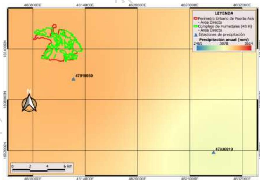
**Figura 26.** Distribución espacial del campo de precipitación en vecindades de los humedales ubicados en Puerto Asís, aplicando el método de interpolación IDW.
