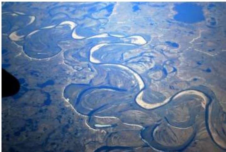
**Figura 13.** Formación de madres viejas o cauces abandonados en un río meandriforme o sinusoidal, propio de relieve de llanura.
