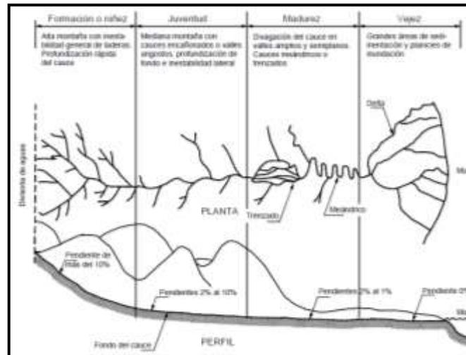
**Figura 12.** Representación esquemática de la vista en planta de un río en áreas de montaña tropical y sus diferentes etapas.
