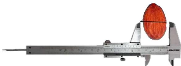
**Figura 8. Medición del ancho en una semilla empleando un calibrador**
