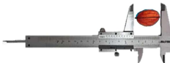
**Figura 9. Medición del largo en una semilla empleando un calibrador**
