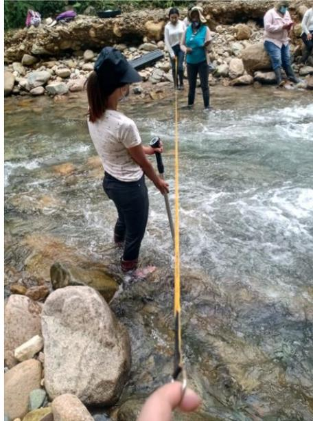
Figura 6. Aforo de caudal por medio del molinete
