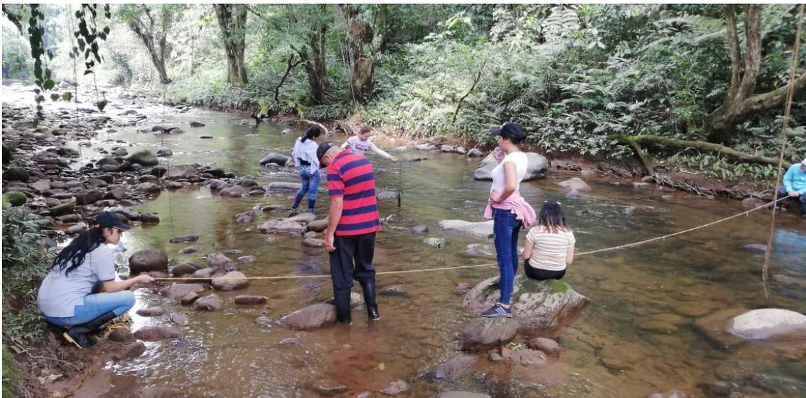
Figura 5. Medición del área de la sección transversal de un cuerpo de agua
