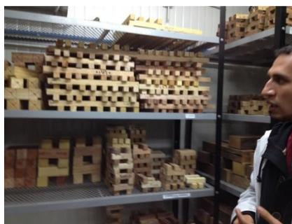
Figura 2. Disposición de las probetas en la cámara de secado. Laboratorio de Maderas Universidad Distrital de Bogotá Fotografía: Edgar Otavo Rodríguez
