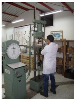
Figura 1. Ensayo mecánico para determinar el cizallamiento. Laboratorio de Maderas Universidad Distrital Francisco José de Caldas, Fotografía: Juan Felipe Solórzano
