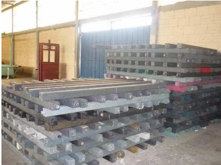
**Figura 31. Postes producidos a partir de la recuperación de plástico en la planta de Madera Plástica, Puerto Asís**
