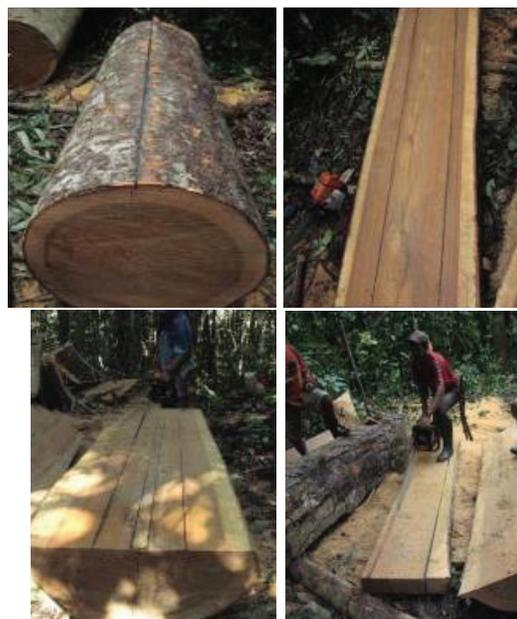
**FIGURA 6.** Ejemplo de agrietamiento en la sección transversal de las trozas colectadas.
