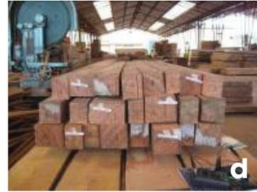
**FIGURA 10.** Proceso de obtención de listones a partir de los tablones: transporte (a), corte transversal (b) y dimensionamiento de listones (c y d).
