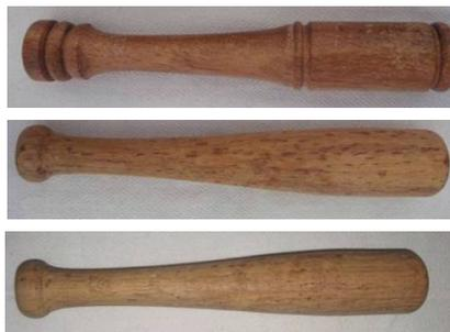
**FIGURA 20.** Prueba al torneado de la madera de Creolino (*Monopteryx uauçu*).
