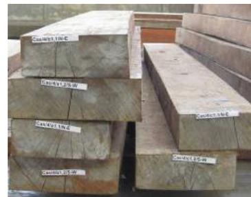
**FIGURA 26** Grietas en los extremos de la madera del Castaño Rojo (*Scleronema praecox*).
