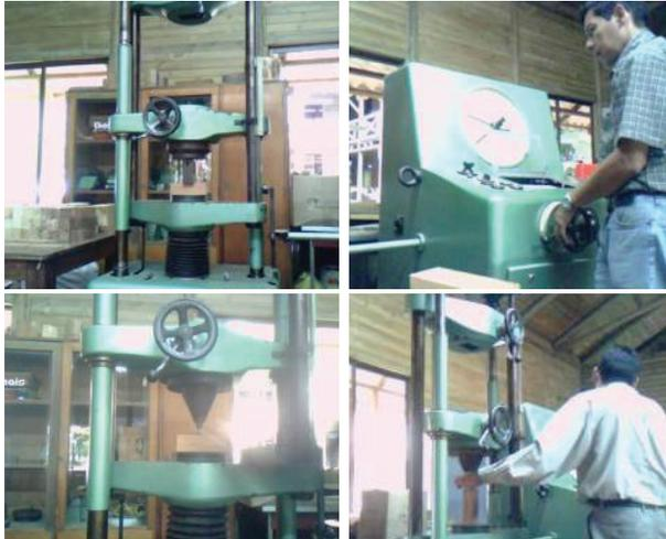
**FIGURA 14.** Procedimiento para la determinación de las propiedades físicas del Creolino, Castaños Blanco y Rojo en la máquina universal de ensayos. Parte superior: ensayo de compresión perpendicular. Parte inferior: Ensayo de Dureza.
