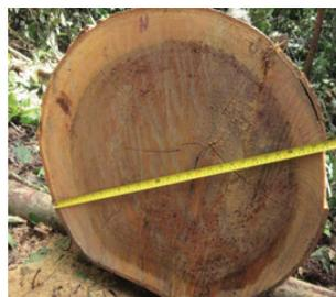
**FIGURAS 5.** Ejemplo de agrietamiento en la sección transversal de las trozas colectadas.
