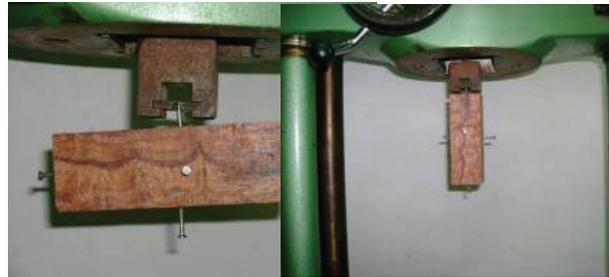
**FIGURA 15.** Imágenes del ensayo de extracción de puntilla, en la maquina universal de ensayos.
