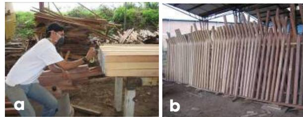
**FIGURA 11** Acondicionamiento de los listones (a) y secado al aire (b).
